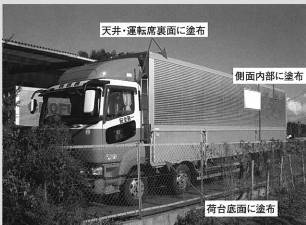
無塗装車両に比べ室温が5℃~10℃低くなり、輸送の品質が高くなった。
